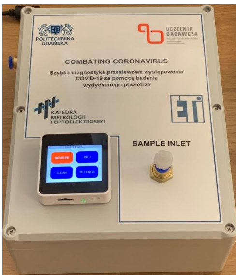
System pomiarowy do analizy próbek powietrza, w tym wydychanego
