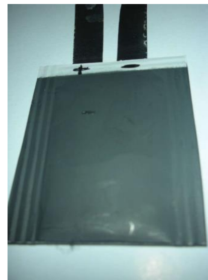
Badane prototypowe superkondensatory (o pojemności ok. 2 F)
