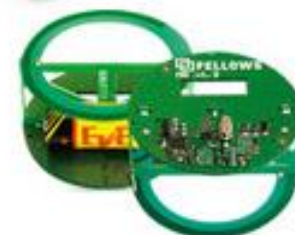
System zdalnego odczytu liczników drogą radiową moRFeus
