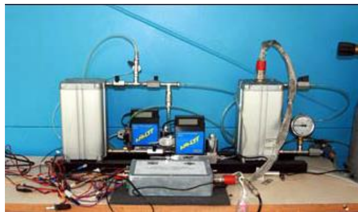
Stanowisko z układem dystrybucji gazów kalibracyjnych i pomiarów sygnałów losowych
